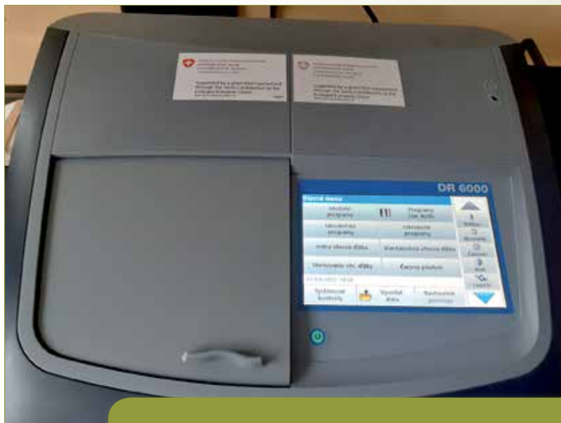
Prístroj – Spektrofotometer (meranie kvapalín – pitná voda)
